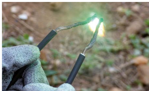
Figure 14. Exemple d'un arc électrique aux bornes d'un module de 200 wp sous 1000 w/m 2 de rayonnement solaire -
